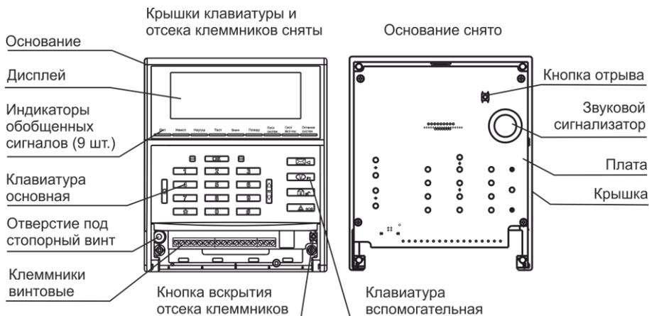
**4.3** На оборотной стороне платы установлены встроенный ЗС и кнопка отрыва, контролирующая отрыв пульта от плоскости установки.
