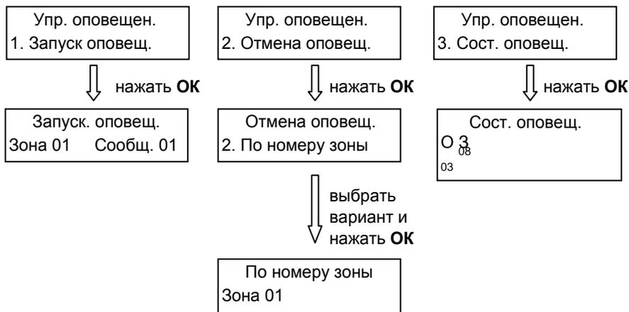
**Выбор зон** производится из списка, пролистывание которого обеспечивается кнопками ▼, ▲, либо цифровыми кнопками.
