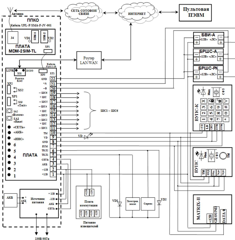
Схема соединений «Заря-УО-IP-GPRS» исп.3 на охраняемом объекте
