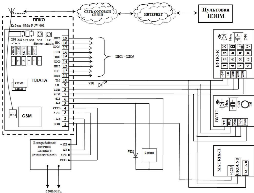
Схема соединений «Заря-УО-IP-GPRS» исп.4 на охраняемом объекте
