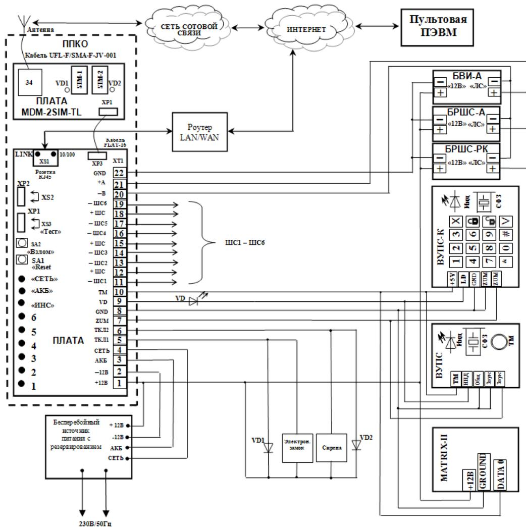
Схема соединений «Заря-УО-IP-GPRS» исп.2 на охраняемом объекте
