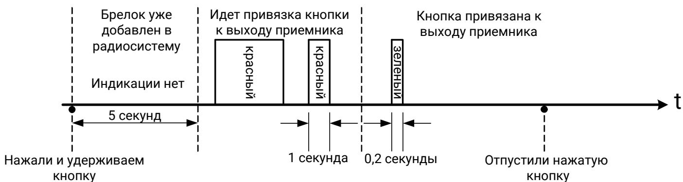
После окончания процедуры проконтролируйте прохождение сигналов по светодиодной индикации и изменению состояния выходов.
