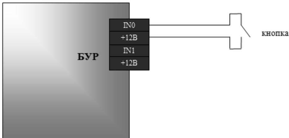
Рисунок 5 – Подключение кнопки «Выход из помещения»
