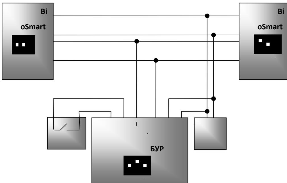
Рисунок 4 – Схема подключения БУР – 2 контроллера BioSmart 4
