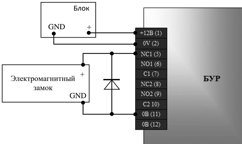
Рисунок 6 – Схема подключения электромагнитного замка
