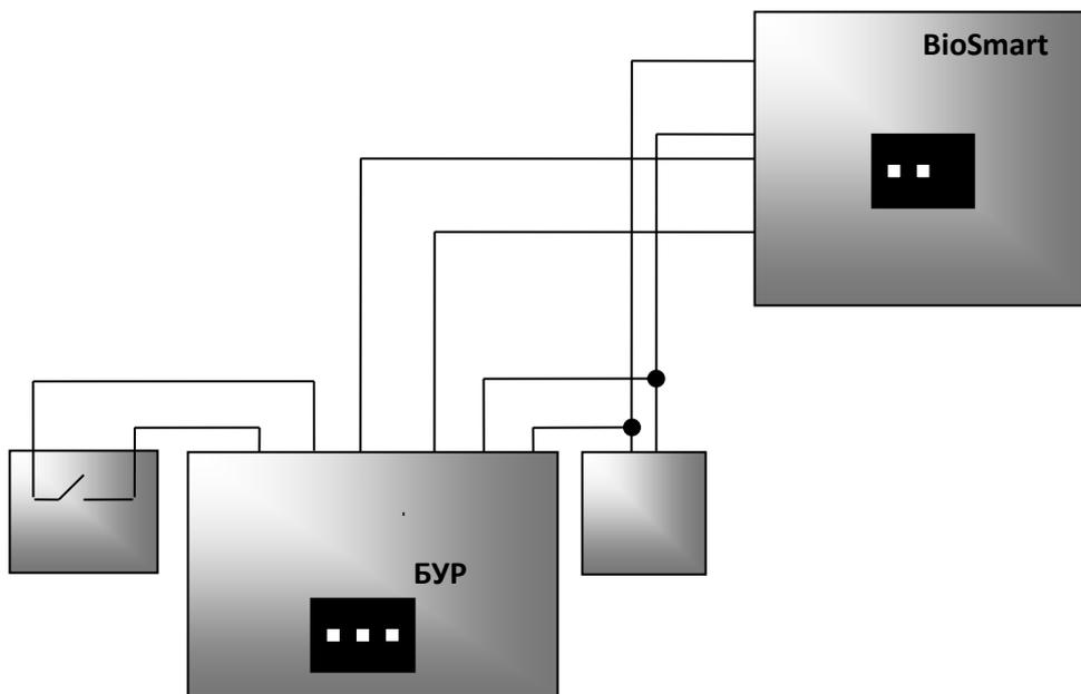
Рисунок 3 – Схема подключения БУР – один BioSmart
