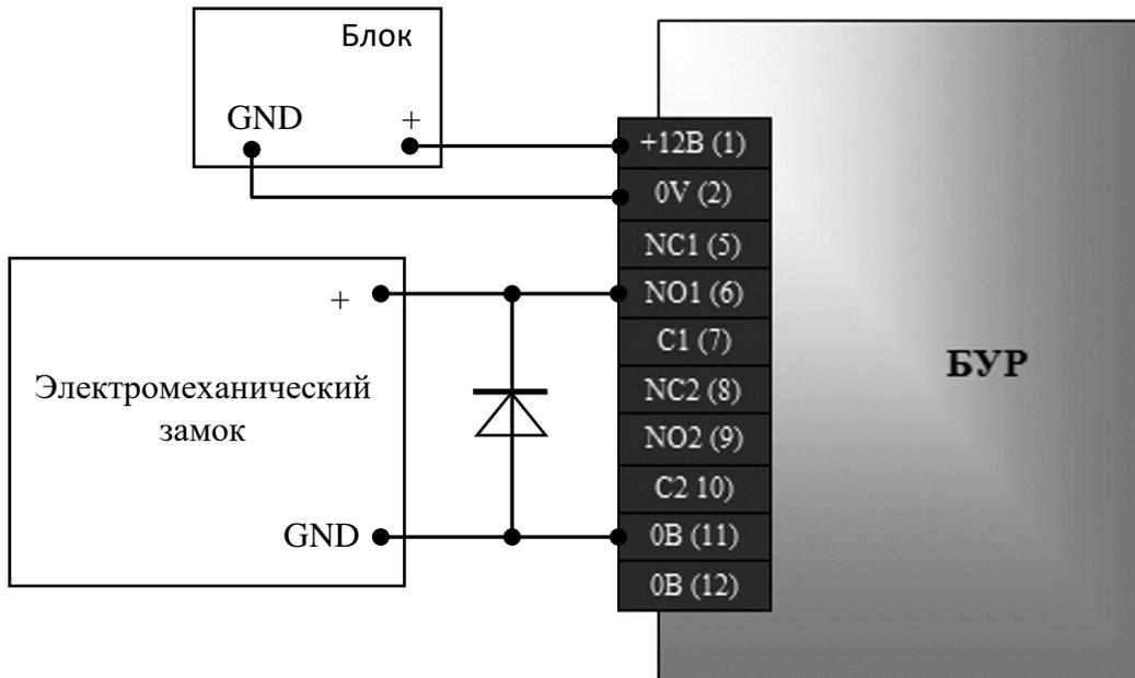
Рисунок 7 – Схема подключения электромеханического замка
