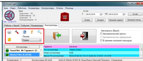
Так же возможно дистанционно открывать проход и переключать режим доступа.
