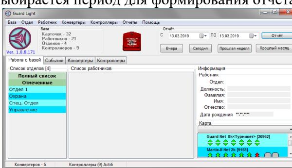
Панель закладок состоит из 4-х закладок: Работа с базой, События, Конвертеры, Контроллеры.
