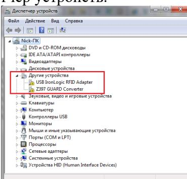
Выбрать неустановившиеся драйверы из раздела «Другие устройства» (USB IronLogic RFID Reader, Z397 GUARD Converter), дважды кликнув по нужному устройству.
