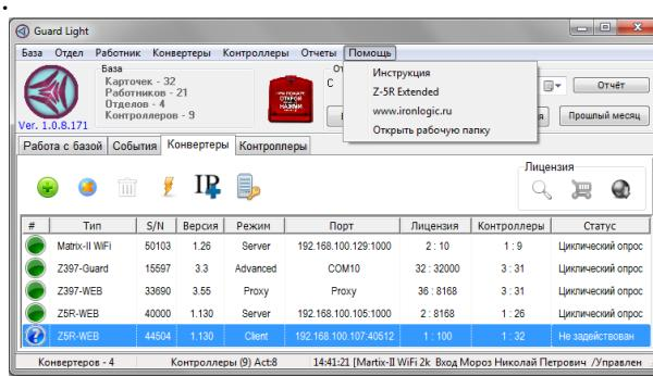
Левый верхний угол программы. Кликнуть правой кнопкой мыши на логотипе программы для вызова контекстного меню: Debug Log (для включения записи лога программы), Config Z5R (для ознакомления с конфигурацией контроллера Z-5R Net Extended), Config Z5RW (для ознакомления с конфигурацией контроллера Z-5R WEB), Config M2WiFi (для ознакомления с конфигурацией контроллера Matrix-II Wi-Fi).
