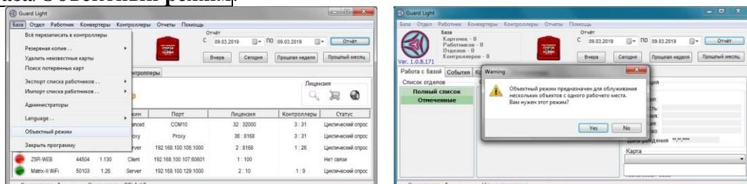
После установки галки на «Объектный режим» появится окно предупреждения. Если Вам нужен объектный режим, то кликните по кнопке «Yes».
