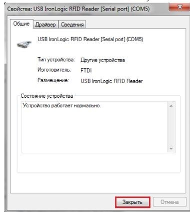
После проделанных операций считыватель (конвертер) установится в системе. В разделе «Контроллеры USB» должна появится запись «*USB IronLogic RFID Reader (Z397-Guard USB<->485)*». В разделе «Порты COM и LPT» должна появится запись «*USB IronLogic RFID Reader [Serial port](COM...)* (Z397-Guard USB<->485 [Serial port](COM...))».
