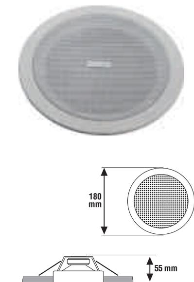
Этот недорогой потолочный громкоговоритель гарантирует высокое качество воспроизведения звука и отличается привлекательным дизайном. Он универсален и обеспечивает высокий уровень звукового давления и широкий диапазон частот. В громкоговорителе использован динамик мощностью 6 Вт с двойным диффузором и трансформатор на 100 В, установленный на задней панели. Громкоговоритель соответствует требованиям CE и RoHS.
