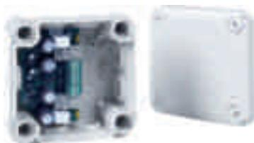
Модуль предназначен для организации линий громкоговорителей повышенной надёжности по кольцевой топологии. Модуль обеспечивает изоляцию коротких замыканий в линиях 100В с сохранением их работоспособности по радиальным подключениям.
