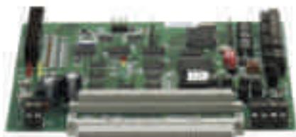
Последовательный интерфейс essernet используется в качестве шлюза для подключения системы речевого оповещения VARIODYN® D1 к системе пожарной сигнализации Esser через сеть essernet. Интерфейс имеет слот для подключения модуля essernet и является полностью совместимым со всеми функциями данной сети.
