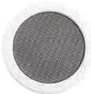
Сенсорный микрофон для реализации функции АРУ (Автоматическая регулировка уровня) на модуле DOM. Микрофон устанавливается в зоне, где необходимо измерять фоновый шум и подключается к соответствующему модулю DOM при помощи настенной розетки XLR (арт.№ 581320).
