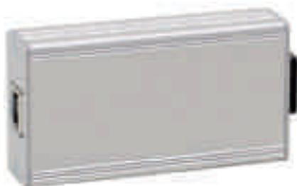
Данный конвертер подключается кабелем линии DAL (кабель CAT5; макс. длина 10 м) к удалённой микрофонной консоли DCS/DCSF или модулю UIM и через многомодовую оптоволоконную линию - к конвертеру 583316.21.
