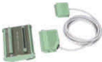
Модуль UIM имеет 48 контактных групп (входов или выходов), разделённых на 4 блока по 12 групп в каждом. В системах, соответствующих требованиям, необходимо использовать модули защиты от перенапряжений 583332 для подключения внешних линий длиной более 3 м. Каждый модуль 583332 обеспечивает защиту 12 контактных групп (1 блок контактов на UIM). Модуль 583332 используется вместо кабеля 583401.21. Кабель подключения входит в комплект его поставки.
