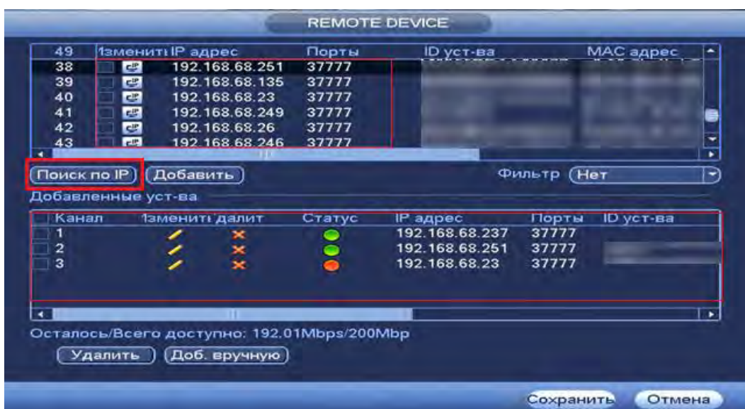
Рисунок 7.31 Настройка добавления камер по поиску в сети.
