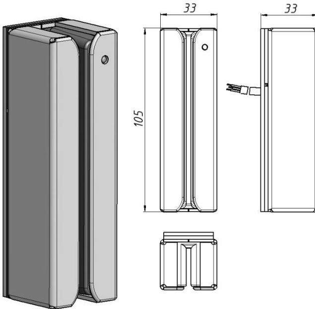
Рис.1. Габаритные и установочные размеры считывателя
