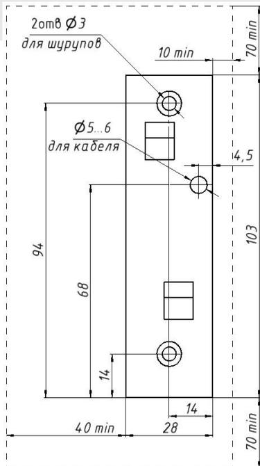
1. Установите основание вертикально на поверхности, как показано на рисунке. От считывателя до ближайших посторонних предметов должно быть: не менее 70 мм сверху и снизу; не менее 40 мм слева.
