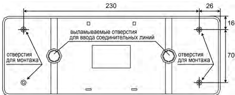
Рис.5 Задняя стенка ВП. Присоединительные размеры
