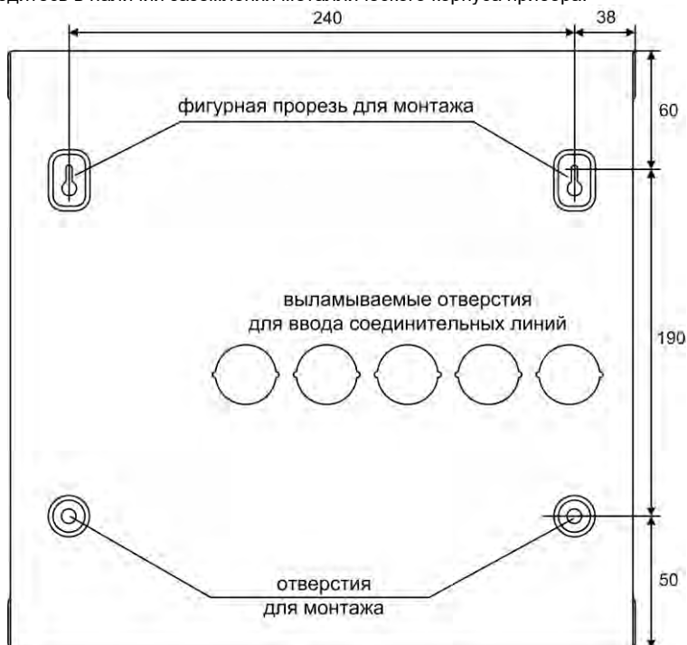
Рис.6 Задняя стенка прибора в металлическом корпусе. Присоединительные размеры
