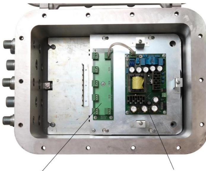
Плата распределения питания 230В Преобразователь напряжения
