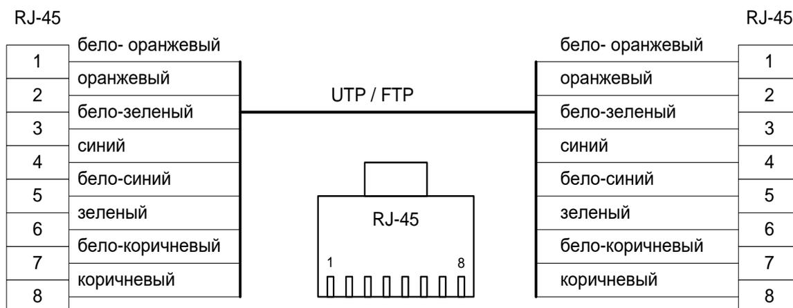
Рисунок 2.2.4 - Разделка Ethernet кабеля.
