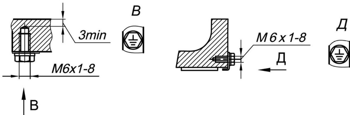
Рисунок 1.4.12 – Установка винта заземления
