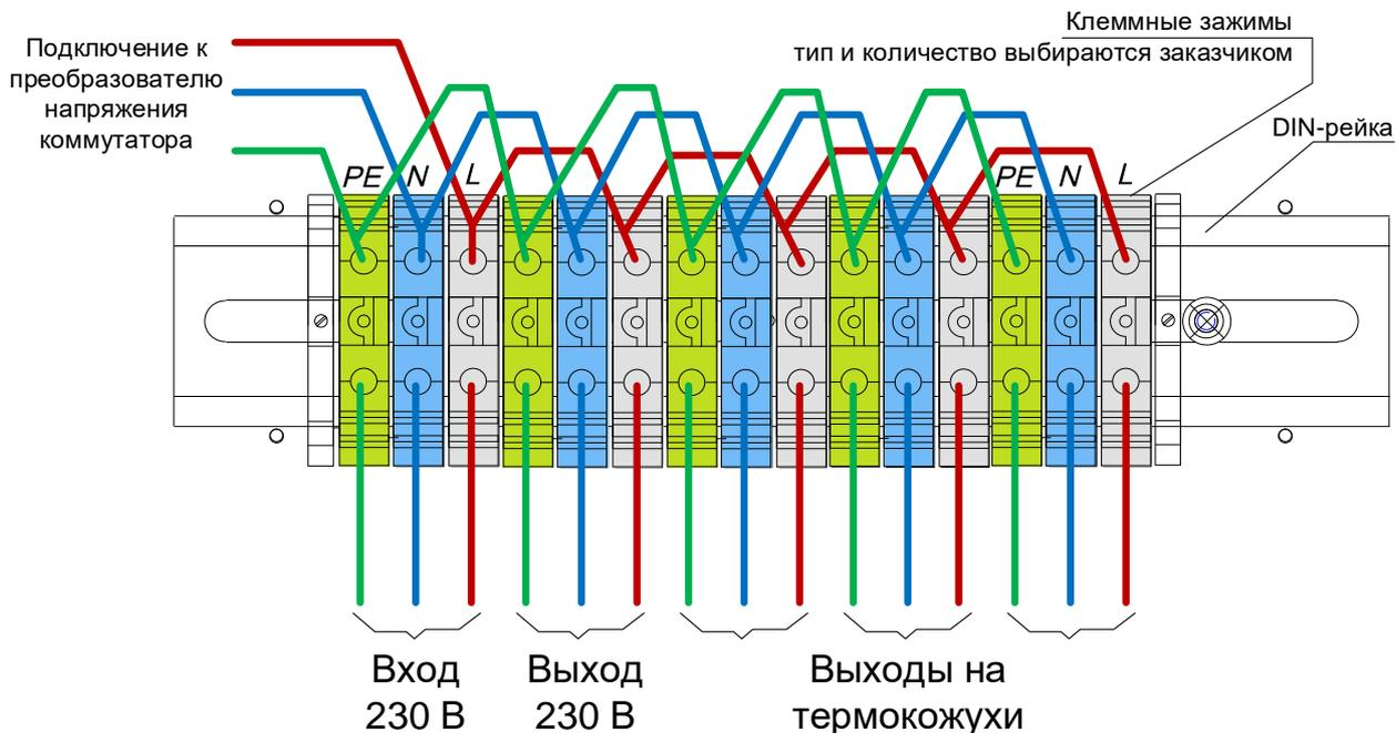
Рисунок 1.4.7 – Схема подключения 230 В с использованием DIN-рейки
