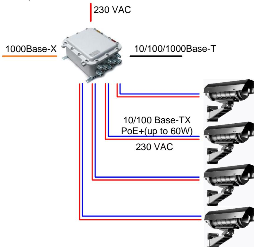
Рисунок 1 - Схема подключения
