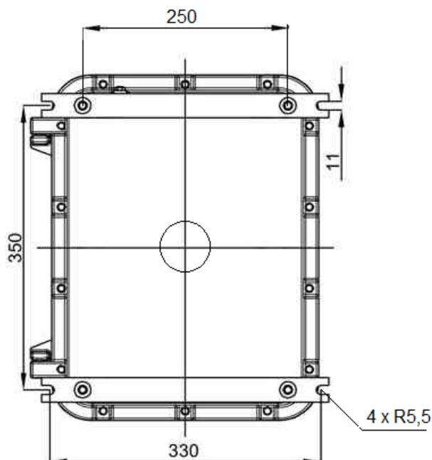
Рисунок 2.2.3 - Разметка крепления
