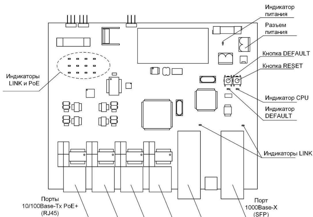
Рисунок 1.4.9 - Расположение элементов на плате коммутатора
