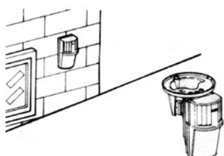
Используйте кронштейны CA-1W для настенного крепления и CA-2C – для потолочного крепления
