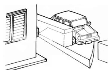
Направьте извещатель на стену или другую преграду для исключения ложных срабатываний
