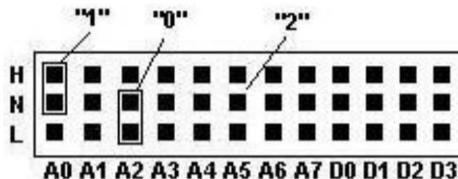
12 рядов перемычек разделены на 2 сектора A0...A7 и D0...D3. Для программирования датчика необходимо выставить перемычки в зоне "A" и в зоне "D" в произвольном порядке, для обеспечения уникального кода датчика.
