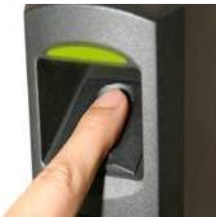
Рисунок 8. Правильное расположение пальца при сканировании
