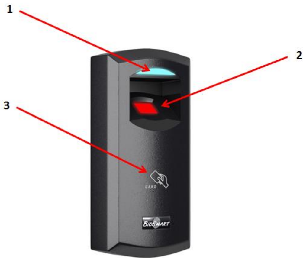
Рисунок 1. Внешний вид контроллера BioSmart 4-О.
