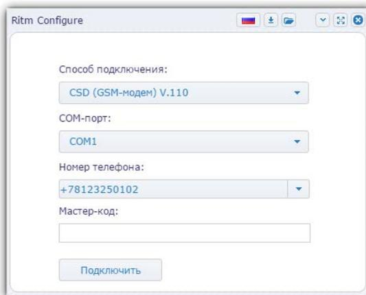
Рисунок 3. Настройка CSD-соединения в программе Ritm Configure
