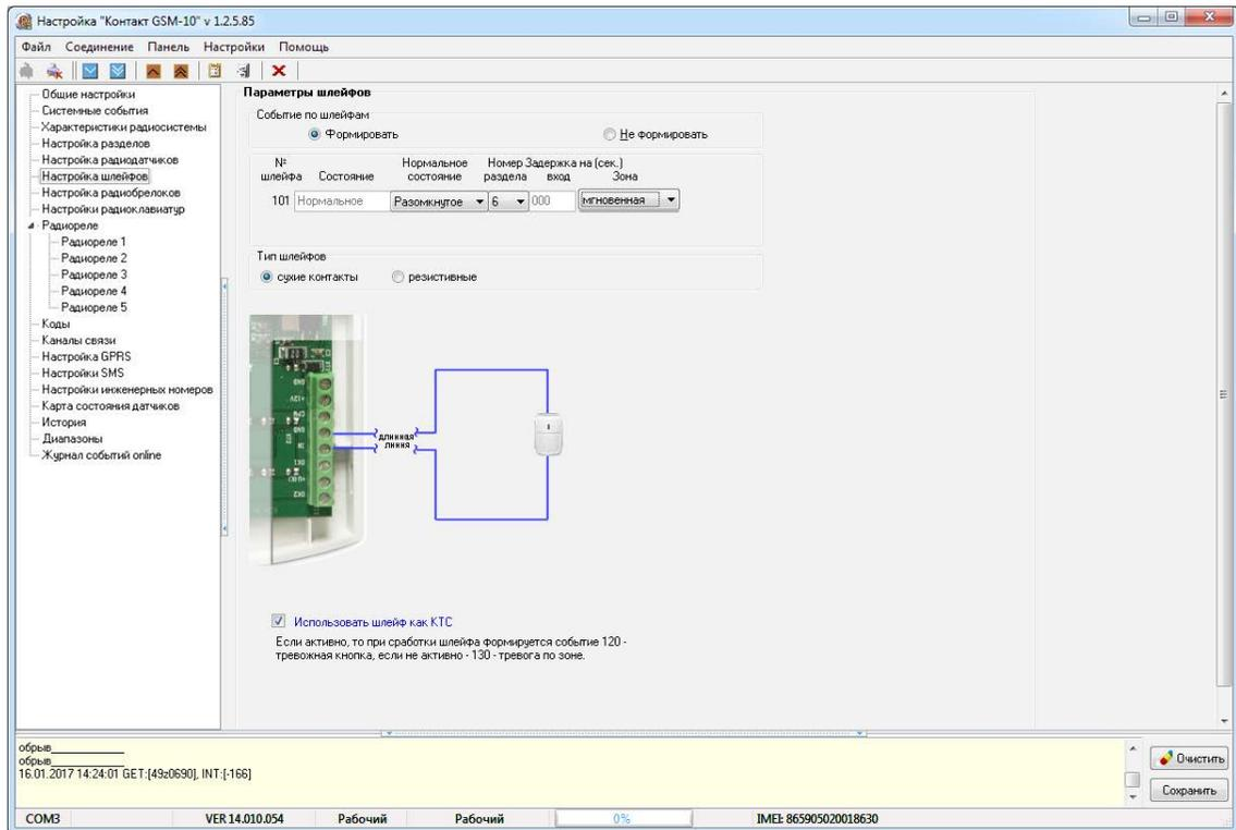
Рисунок 21. Настройки шлейфов: шлейфы типа «сухой контакт»
