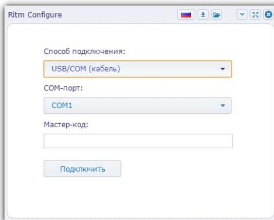
Рисунок 4. Настройка USB-соединения в программе Ritm Configure
