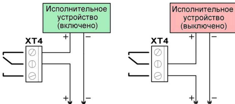
Рисунок 25. Примеры подключения исполнительных устройств к радиореле
