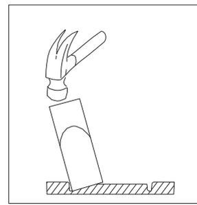
Рис. 4. Пробивка отверстий для установки кабелепровода
