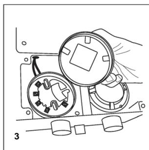
**НЕ** меняйте дымовые извещатели местами и **НЕ** меняйте положения поворотных переключателей адреса на них. При замене дымового извещателя удостоверьтесь, что установленный на новом извещателе адрес такой же, как был на заменяемом.
