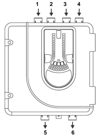
**Рис. 8. Отверстия для труб**
