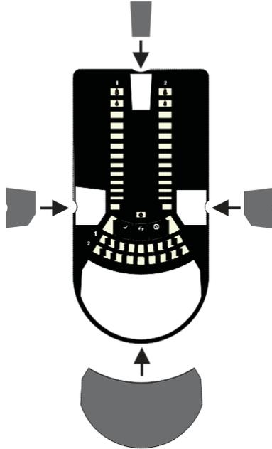
Рис. 2. Размещение вкладышей лицевой панели
