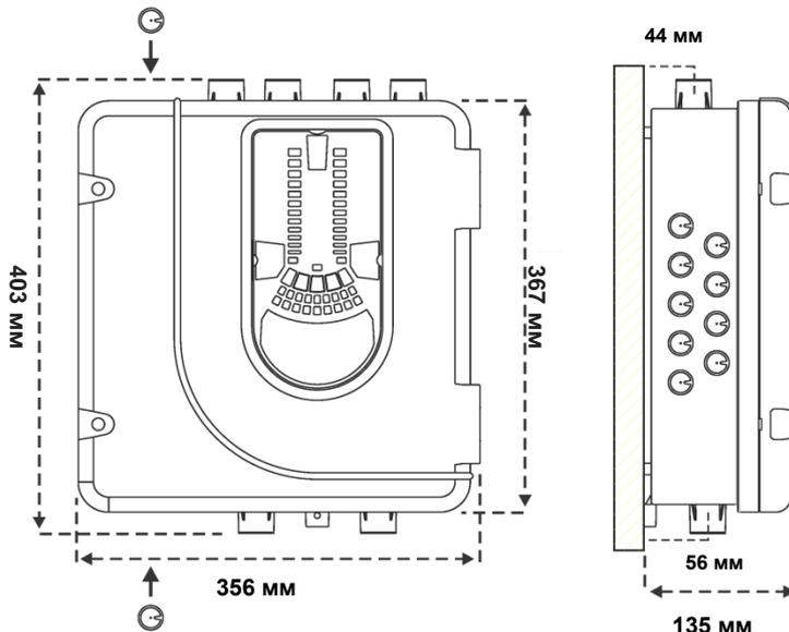
**Рис. 1. Наружные размеры и расположение намеченных отверстий**
