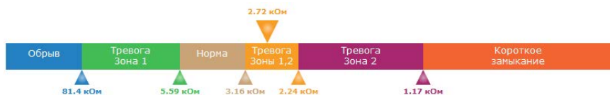
Рисунок 26. Шкала порогов охранного шлейфа
