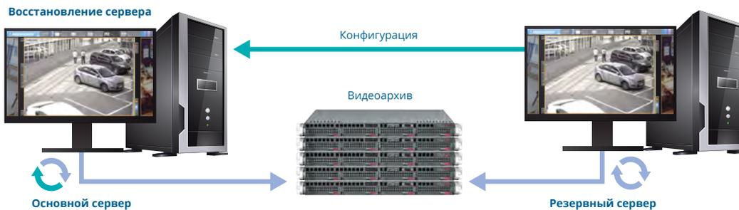
При потере связи с основным сервером автоматически подключается резервный сервер, который выполняет все функции основного. Трансляция видео на экране оператора и запись в архив сразу же возобновляются. Любой сервер в кластере можно приостановить (например для обслуживания) без прерывания работы системы видеонаблюдения.
