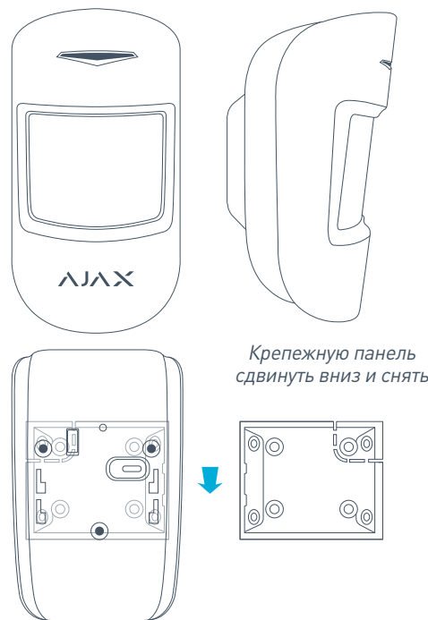
РИС. 1. Датчик движения MotionProtect и его крепежная панель
