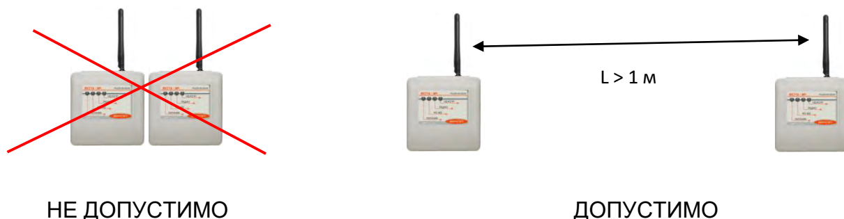
Рис. 1. Взаимное расположение радиомодемов «ВЕТТА-МР» одной системы «ВЕТТА-2020»
