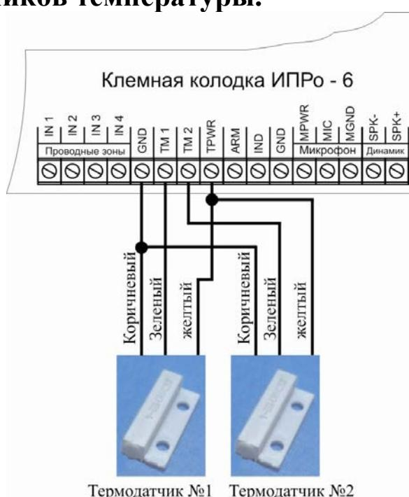
Подключения 2-х датчиков
