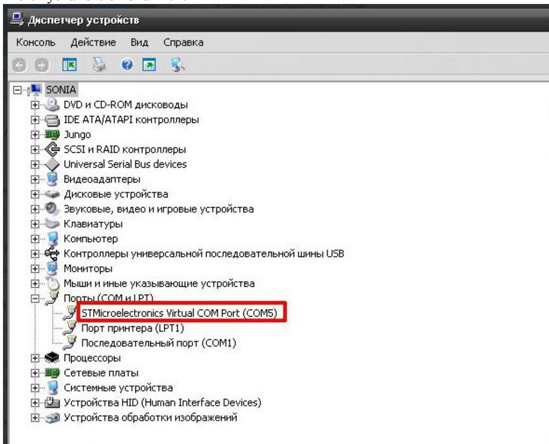
Для устранения ошибки, необходимо отключить Прибор от USB и перезагрузить компьютер. После перезагрузки заново подключить Прибор к USB разъему, ошибка должна быть устранена. Если перезагрузка не помогла, переустановите USB драйвер.
