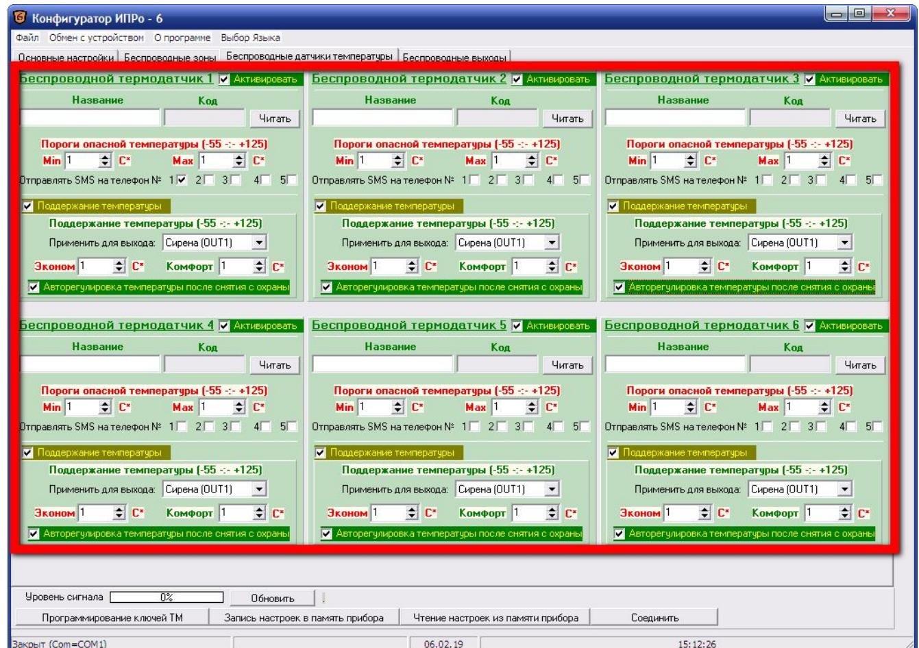
Настройку беспроводного датчика температуры рассмотрим на примере датчика №1.
