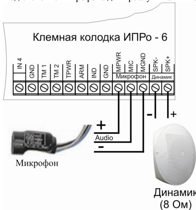
Для работы в составе системы используются специализированные микрофоны, имеющие встроенный усилитель и допускающие подключение с помощью длинных проводов (**до 100 метров**).
