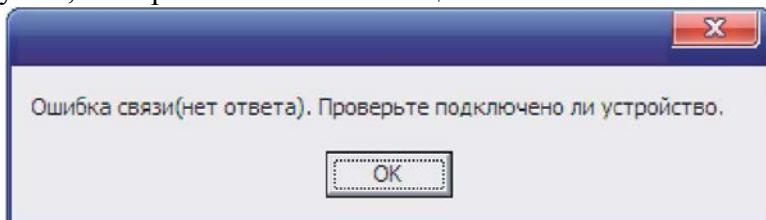
Нажмите кнопку «OK» и подождите 1 минуту, затем еще раз нажмите кнопку «Соединить». Если вновь появляется окно с ошибкой, то одной из причин этого может быть неверная установка драйвера USB. Проверьте правильно ли установлен драйвер USB (см. пункт 2.3 «Подключение USB шнуря»).
