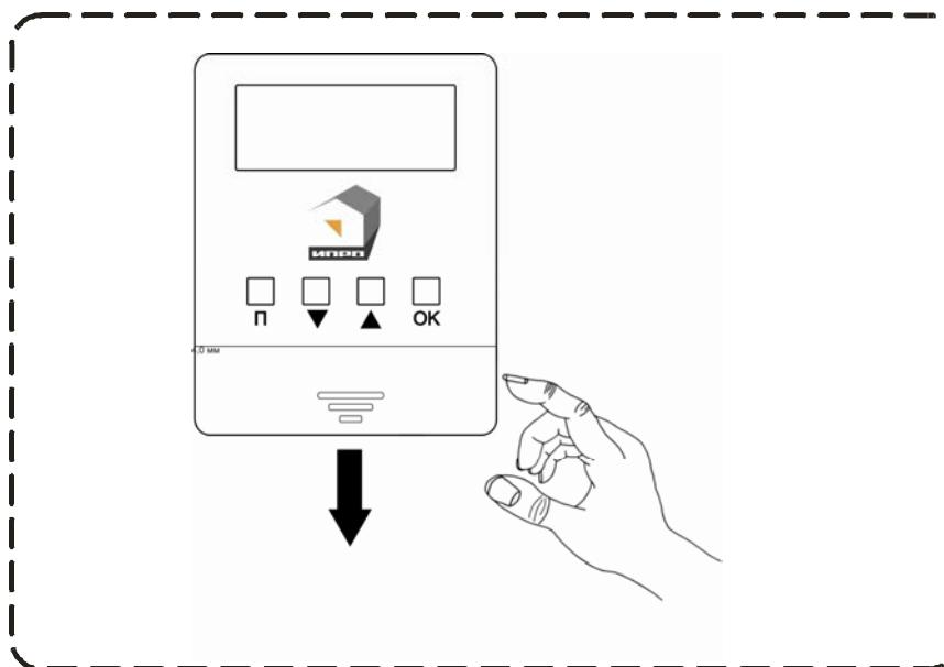
Подключите батарейку (тип «Крона») к разъемам устройства. При подключении соблюдайте полярность и форму разъемов:
