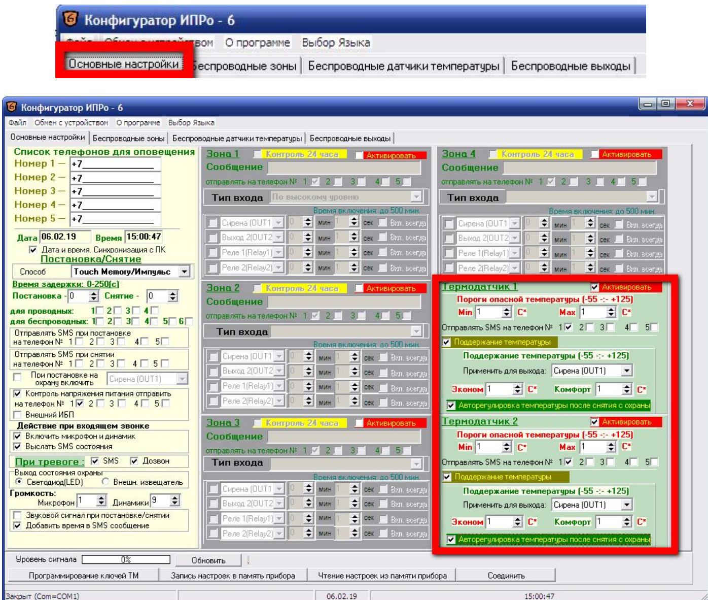
К прибору можно подключить 2 проводных датчик температуры. Диапазон измеряемых температур: **-55°C до +125°C**.
