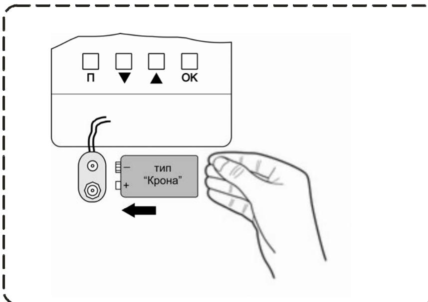
Установите батарейку в батарейный отсек и закройте крышку.
