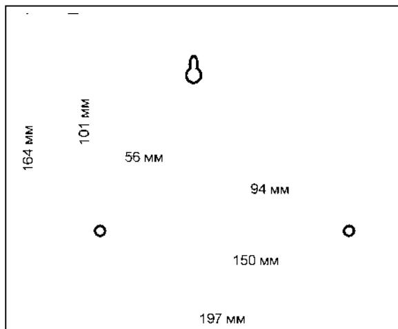
закрутить верхний шуруп, оставив расстояние до стены 6 мм. Навесить прибор на верхний шуруп, затем выровнять прибор и завернуть нижние шурупы. Для удобства монтажа можно извлечь плату прибора.
