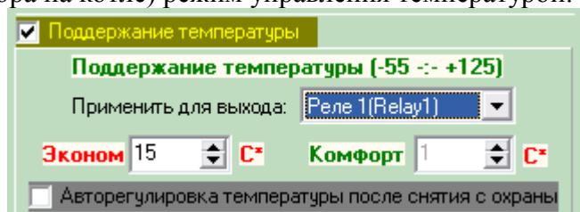
Если нужно автоматически управлять температурой при снятии с охраны, нужно установить флаг «Авторегулировка температуры после снятия с охраны». Поле «Комфорт» становится активным.
