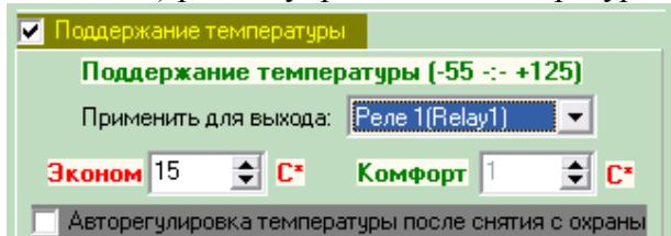
Если нужно автоматически управлять температурой при снятии с охраны, нужно установить флаг «**Авторегулировка температуры после снятия с охраны**». Поле «**Комфорт**» становится активным.
