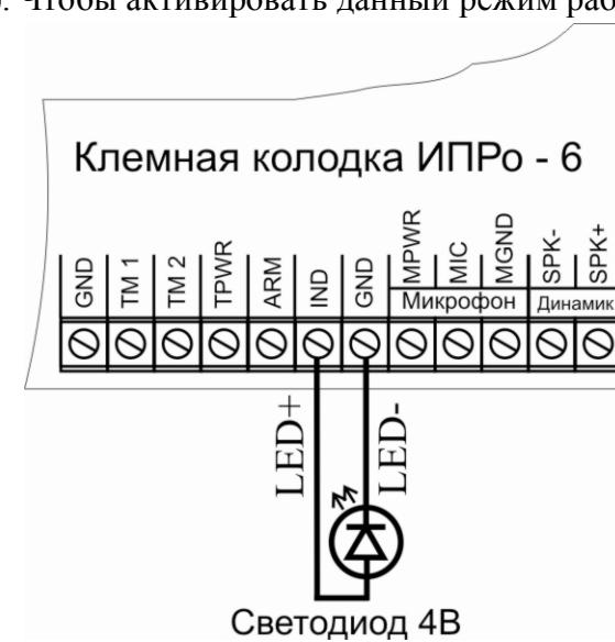
Внешний световой извещатель. В данном режиме работы Выход «IND» является выходом «-12В» (ток до 500mA). Чтобы активировать данный режим работы нужно выбрать пункт «Внешн.известатель».
