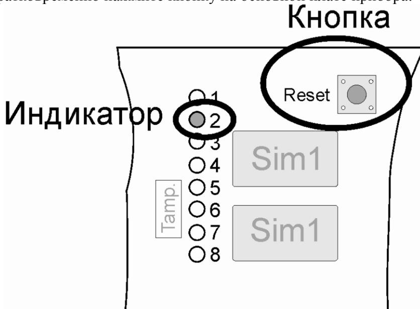
Индикатор «GSM» начнет мигать с частотой 2 раза в секунду.
