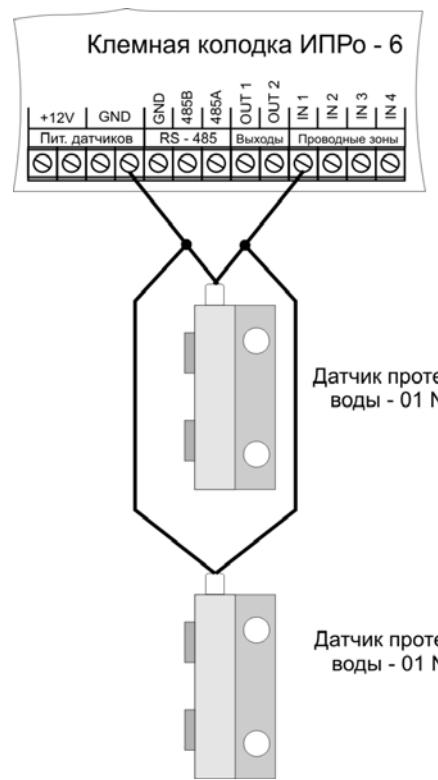
Подключение 2-х датчиков
