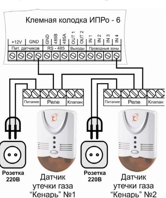
**Подключение 2-х датчиков**
