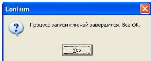
Если таблица с необходимыми ключами заполнена, производим запись в Прибор. Для этого, нажимаем кнопку «Сохранить», после чего ключи запишутся в Прибор. В течение 2-3 секунд должно отобразиться окно:
