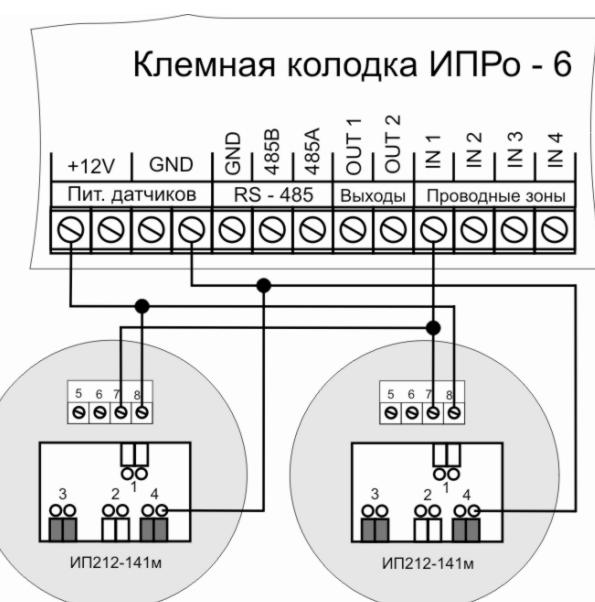
**Подключение 2-х датчиков**
