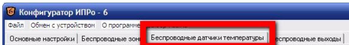
К прибору можно подключить 6 беспроводных датчиков температуры. Диапазон измеряемых температур: **-55°C до +125°C**.
