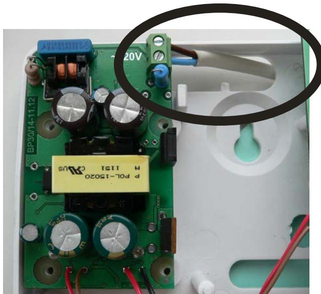
После подключения проводов, можно установить плату на место. Проверьте, надежно ли заизолированы контакты.
