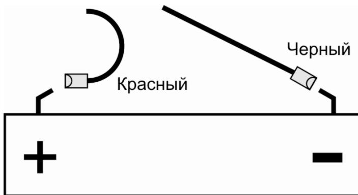
**ВНИМАНИЕ!!!** При включении прибора, первоначально запитанного только от аккумулятора, прибор стартует в режиме ограниченной функциональности (прибор не регистрируется в сети и не управляет внешними SMS-сообщениями). Для работы прибора в режиме нормальной функциональности при включении должно быть подключено сетевое питание 220В, аккумулятор подключается в последнюю очередь.
