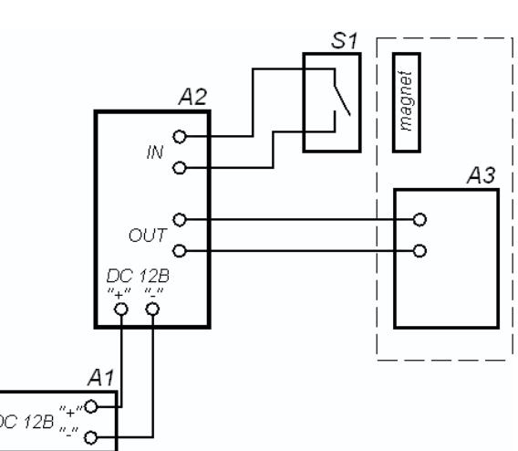
Рис.2 Схема подключения замка
