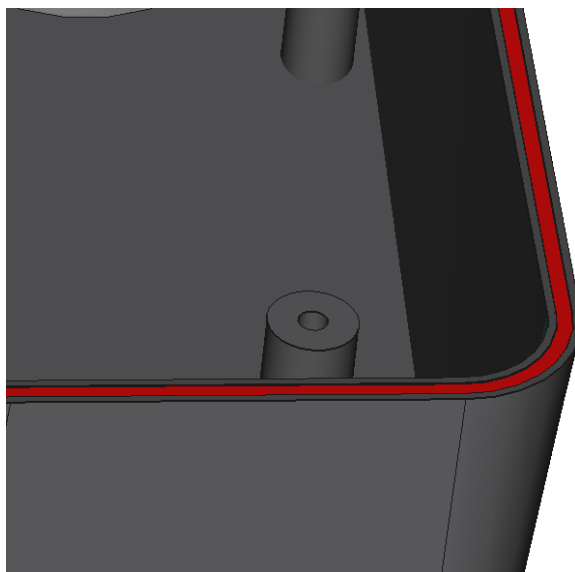
Рисунок 10 – Выемка с уплотнительной резинкой на корпусе считывателя и выступ на задней крышке.
