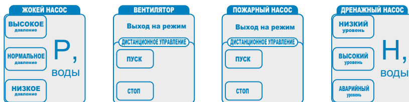
Рисунок 5- Сменная этикетка панели управления ШУ
