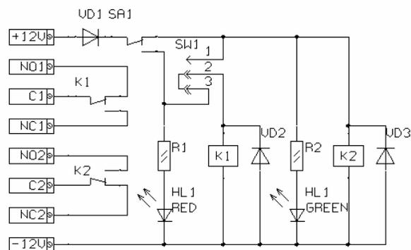
Выходные контакты извещателя позволяют коммутировать ток до 3А постоянного напряжения 24В или 120В переменного.
