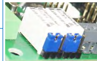
Контакты реле PAS нормально разомкнуты (состояние поставки)
